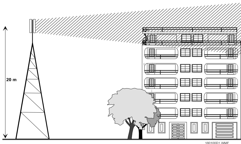
Figure 6 – Bâtiment situé dans le faisceau
