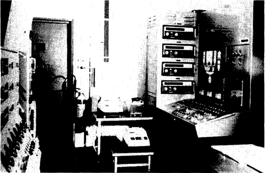
Figure 6 : Salle de commande pour dosage, transfert de poudres, mélange de poudres
