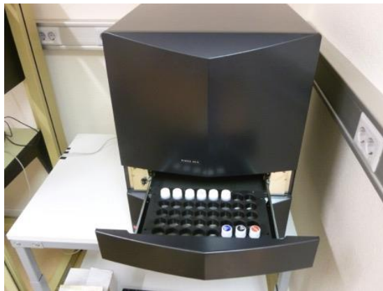
Fig. 6 : Compteur en scintillation liquide pour la mesure du tritium ou du radon dans l'eau.
